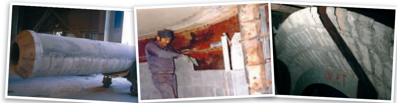
Teilweise vorgefertigtes Brennerrohr, USA
